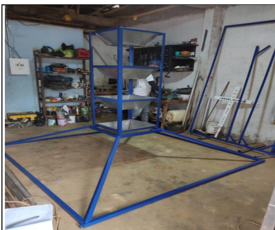
Actividad: Torre de aireación
